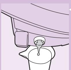
7 เทน้ำออกจากแท้ก้น้ำ ใส่ในถังหรืออ่าง
