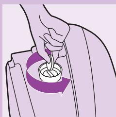
**4** 将蒸发水箱转向侧面，用特制的钥匙或硬币拆下水垢清洗
