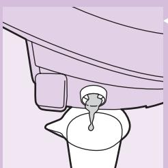
5 เทน้ำออกจากแท้ก้น้ำ ใส่ในถังหรืออ่าง
