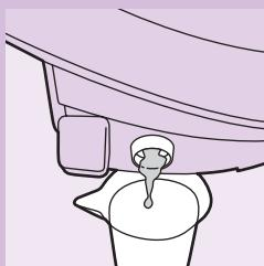
**5** 将蒸发水箱中的水倒入杯子或水池内。
