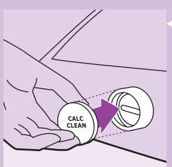
**9** 将水垢清洗鉗装回蒸发水箱。
