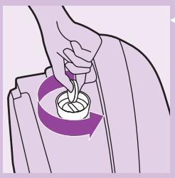
4 หมุนแท้ก้น้ำกลับเข้าไปที่เดิม และถอดไฟของอุปกรณ์จัดระดับน้ำออกด้วยกุญแจหรือใช้เที่ยญที่จะ
