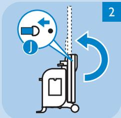
**2** Lösen Sie den Sicherungsgurt **J**, und klappen Sie das Bügelbrett in senkrechte Position auf. Stellen Sie beide Belüftungsschieber **D** in die Bügelposition.
