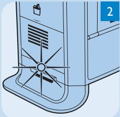
2 Nach ca. 3 Minuten wird das ausgespülte Wasser in das Spülfach unten gespült. Das akustische Signal ertönt schneller, und am Spülfach blinkt die Anzeige rot.
