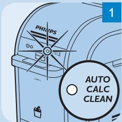
1 Wenn der automatische Calc-Clean-Vorgang aktiviert ist, blinkt die Anzeige für den automatischen Calc-Clean-Vorgang blau, und das Gerät gibt ein akustisches Signal ab.
