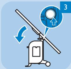
**3** Drücken Sie die Bügelbrett-Kipptaste **H**, und bringen Sie das Bügelbrett in waagerechte Position. Stellen Sie das Bügelbrett auf die passende Höhe ein. Verwenden Sie dazu den Hebel zur Höheneinstellung **I**.
