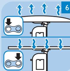
**6** Wenn Sie die Blasfunktion des Bügelbretts verwenden möchten, drücken Sie die Blastaste des Bügeleisens. Wenn Sie die Saugfunktion des Bügelbretts verwenden möchten, drücken Sie die Saugtaste des Bügeleisens.
