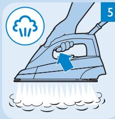
**5** Wenn Sie mit Dampf bügeln möchten, stellen Sie den Temperaturregler des Bügeleisens auf ●● oder höher und drücken Sie die Dampftaste **T**. Richten Sie den Dampfstoß niemals auf Personen!
