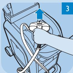
**3** Nehmen Sie die Dampfeinheit aus ihrem Fach. Drücken Sie den Ein-/Ausschalter der Dampfeinheit **U**, um die Dampfeinheit einzuschalten. Die Betriebsanzeige leuchtet auf.
