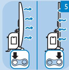
**5** Wenn Sie die Blasfunktion verwenden möchten, drücken Sie die Blastaste der Dampfeinheit. Wenn Sie die Saugfunktion verwenden möchten, drücken Sie die Saugtaste der Dampfeinheit.
