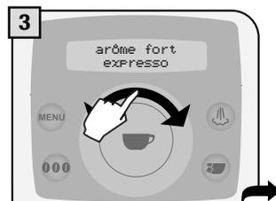
3 Sélectionner la boisson désirée en faisant glisser le doigt sur le disque de sélection.
