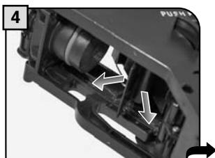
Distribuer la graisse de façon uniforme sur les des convoyeurs latéraux.
