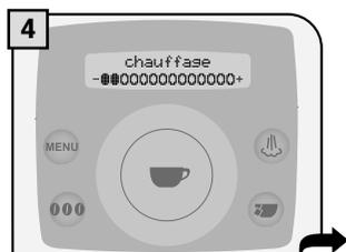
Attendre que la machine termine la phase de chauffage.
