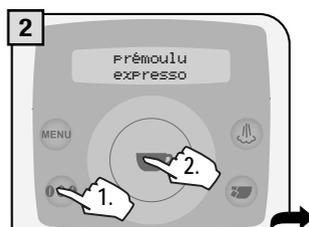
Sélectionner la fonction en appuyant sur la touche **000** jusqu'à ce que l'option prémoulu apparaisse. Confirmer en appuyant sur
