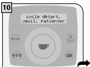
La machine commence à distribuer la solution détartrante dans la buse de distribution de l'eau chaude. La distribution a lieu à des intervalles préétablis pour permettre à la solution d'agir de façon efficace.
