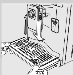
**5** Tørk dråpesamleren, monter den og sett den på plass på maskinen igjen.
