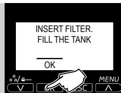
**12** Trykk på tasten "OK" for å bekrefte at vannfilteret er satt i og beholderen er fylt.
