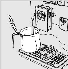
**4** Uttaket av varmt vann begynner. For å stanse uttaket tidligere trykker du på tasten "V".
