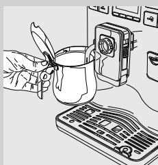
**1** Plasser en beholder med produktet du ønsker å varme opp under damp-/varmvannsrøret.
