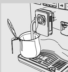
**1** Plasser en beholder under damp-/varmtvannsrøret.
