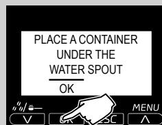
**13** Trykk på "OK" for å bekrefte at det finnes en beholder under vannutaket.
