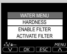
**7** Velg alternativet HARDNESS ved å trykke på tasten "OK" og programmer vannhardhetsverdien.
