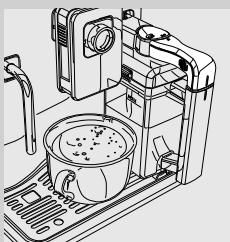
**4** Maskinen begynner å føre ut varmt vann. For å stanse uttaket tidligere trykker du på tasten "V".
