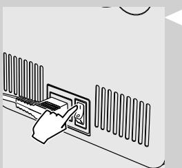
**12** Sett hovedbryteren på "I" for å slå på maskinen.
