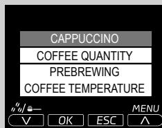
Maskinen gjør det mulig å regulere korrekt mengde malt kaffe til hvert produkt. Standardreguleringen, for hvert produkt kan programmeres med menyen "BEVERAGE MENU" (se kapittelet "Programmering av drikker", alternativet "Kaffemengde").
