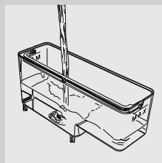
**10** Når du er ferdig, fyller du vannbeholderen på nytt opp til MAX-nivået. Nå er maskinen klar til bruk og til å tilberede kaffe.
