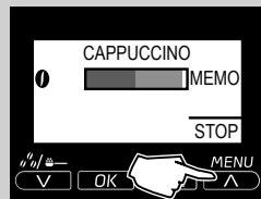
**5** Når dette skjermbildet vises, starter maskinen uttaket av melkeskum i koppen. Trykk på tasten "MENU" når du har oppnådd ønsket melke-mengde.
