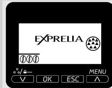
Under bruk danner det seg kalk inne i maskinen, og denne må fjernes regelmessig. Hvis ikke vil både vann- og kaffekretsen kunne tettes igjen. Det er maskinen som varsler om når den behøver avkalking.
