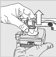
**6** Trekk ut håndtaket med oppsugingsrøret.
