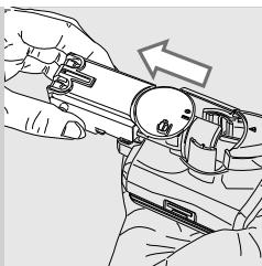
**5** Trekk ut konnektoren som er i kontakt med maskinen.
