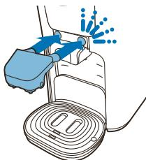
**8** Schuif de melktuit terug in het apparaat over de geleiderails op de koffietuit. U hoort een klikgeluid wanneer de melktuit goed is bevestigd.
