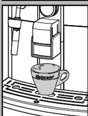
Nastavenie je možné uskutočniť manuálne podvihnutím alebo spustením výtoku tak, ako je to uvedené na obrázku.
