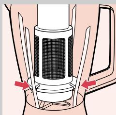
**3** Placez le couvercle sur le bol pour fixer le filtre en place.
