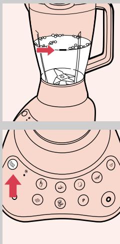
**1** Versez de l'eau tiède et un peu de produit vaisselle dans le bol mixer, pour remplir 1/2 du bol. Ne dépassez pas ce niveau lorsque vous utilisez la fonction Nettoyage Rapide.
