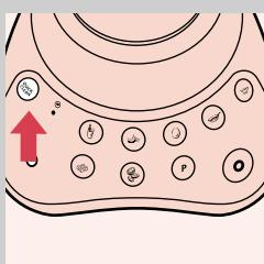
**1** Deite água ténida e um pouco de líquido da loiça dentro do copo misturador, até 1/2 da altura. Não exceda esta quantidade quando usar a função 'Quick Clean'.
