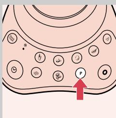
► Se não ficar satisfeito com o resultado quando estiver a processar ingredientes sólidos, desligue a máquina e deixe-a trabalhar brevemente, um par de vezes, premindo o botão 'Pulse' (batimento). Quando se prima o botão 'Pulse', o motor trabalha na velocidade máxima.
