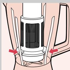
**1** Coloque o filtro no copo misturador. Verifique se o copo está desligado da unidade do motor antes de colocar o filtro.
