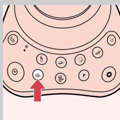
**8** Wählen Sie die erforderliche Einstellung, indem Sie die entsprechende Taste drücken. Das Gerät wird dadurch automatisch eingeschaltet.
