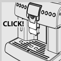
*Nota: prima di ogni erogazione e/o quando si riporta l'erogatore in posizione di erogazione normale, assicurarsi che sia correttamente posizionato; questo si avverte quando si sente il CLICK che indica il corretto posizionamento. In caso contrario si potrebbero avere delle fuoriuscite di prodotto dall'esterno dell'erogatore.*
