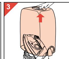
(Vain mallit HI 559 ja HI 569:) Irrota (kuva 2) ja nosta kotelo pois (kuva 3).
