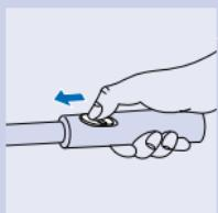
**2** Μπορείτε να λειτουργήσετε τη συσκευή χρησιμοποιώντας το συρόμενο διακόπτη επάνω στη χειρολαβή του ρύγχους. Μπορείτε να χρησιμοποιήσετε τη συσκευή μόνο στη θέση II (turbo απορροφητική δύναμη) εάν έχετε συνδέσει το ρύγχος.
