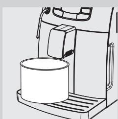
**8** 在蒸汽/热水冲煮管和咖啡流出口下方放置一个大容量器皿（1.5 升）。
