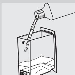
**6** 取下水箱，并将整瓶 Saeco 除垢剂中所含物质倒入其中。将清水注入水箱内，直至 MAX（最大）水位线。
