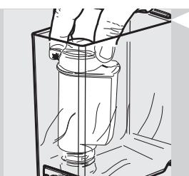
**4** 将滤水器放入空水箱。将滤水器按到底，安装到位。
