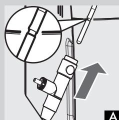
**21** Cappuccinatore（自动奶泡器）插到底座上，直至锁定到位（图 A）。
