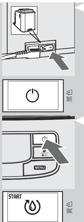
**12** 将电源按钮置于“**I**”的位置上启动咖啡机。显示屏显示待机图标。
