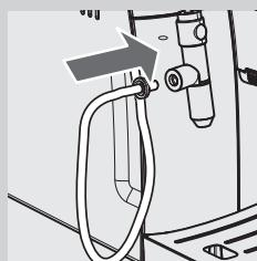
**12** 将连有吸管的固定针放回到 Cappuccinatore（自动奶泡器）中。
