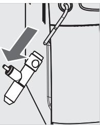
**2** 从热水/蒸汽冲煮管上取下 Cappuccinatore（自动奶泡器）。
