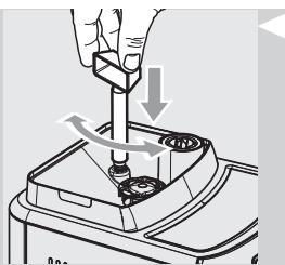
**1** 按住并转动研磨器调整旋钮，每次转动一格。冲泡 2-3 杯意式浓缩咖啡，只有这样，你才能品辨出研磨上的差异。
