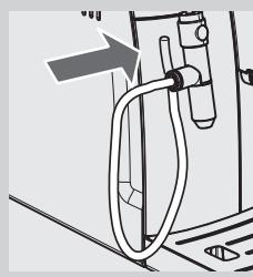
7 将连有吸管的固定针放入 Cappuccinatore (自动奶泡器) 中。
