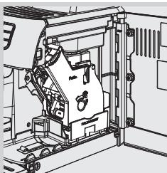
**3** 将咖啡冲泡器重新安装至底座上，直至锁定到位。（参阅“每周清洁咖啡冲泡器”章节）。插入咖啡渣槽。
