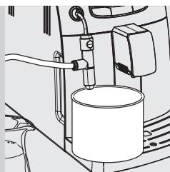
**10** 倒空器皿，再将它放回到 Cappuccinatore（自动奶泡器）下。
