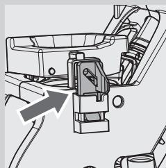
**10** 确保锁定咖啡冲泡器的挂钩位置正确，可以用力按下“PUSH”（压）按钮直到听到咬合声。检查挂钩是否挂到位。如未到位，请重试。
