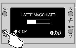
**7** Ko se prikaže naslednji zaslon, aparat sproži točenje mlečne pene. Za predhodno prekinitev točenja pritisnite tipko " **ESC** " .
