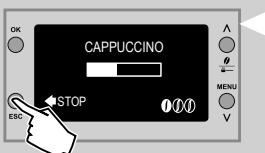
**7** Ko se prikaže naslednji zaslon, aparat sproži točenje mlečne pene. Za predhodno prekinitev točenja pritisnite tipko "ESC".
