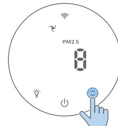
**Automatski način rada (Ⓐ):** pročišćivač zraka automatski podešava brzinu ventilatora sukladno kvaliteti zraka u okruženju.
