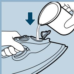
Nel caso l'acqua della vostra zona fosse particolarmente dura, vi consigliamo di mischiare con la stessa quantità di acqua distillata o di usare solo acqua distillata.
