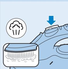
A função super vapor apenas pode ser utilizada nas definições de temperatura entre ●● e MAX.
