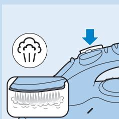
Güçlü buhar püskürtme, inatçı kırışıklıkların giderilmesine yardımcı olur. Buhar püskürtme fonksiyonu sadece ●● - MAX arasındaki sıcaklık ayarlarında kullanılabilir.
