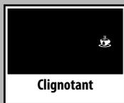
**i** Parfois il se peut que, lorsqu'on tourne le bouton, l'eau chaude ne s'écoule pas et le symbole commence à clignoter sur l'afficheur. Attendre la fin de la phase de chauffage, pour que de l'eau chaude sorte du Pannarello.
