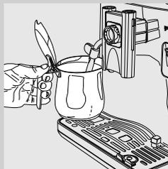
1 Einen Behälter mit dem Produkt, das erhitzt werden soll, unter die Dampf-/Heißwasserdüse stellen.
