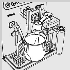
**15** Den Behälter leeren und unter den Kaffeeauslauf stellen. Die Düse der Milchkaraffe öffnen, indem sie im Uhrzeigersinn gedreht wird.
