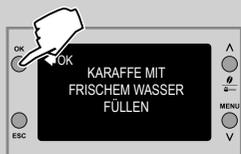
**14** Die Milchkaraffe sorgfältig reinigen und mit frischem Wasser füllen. Die Milchkaraffe in die Maschine einsetzen. Zur Bestätigung die Taste "OK" drücken.
