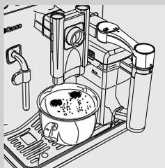
**4** Die Düse der Milchkaraffe öffnen, indem sie im Uhrzeigersinn gedreht wird.
