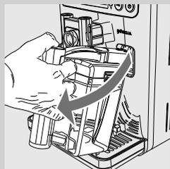
**13** Die Milchkaraffe und den Behälter von der Maschine entfernen.
