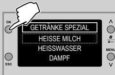
3 Nach der Anwahl von "HEISSE MILCH" durch Druck der Taste "V" oder "∧" mit "OK" bestätigen.
