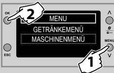
**7** Die Taste "MENÜ" drücken, um das Hauptmenü der Maschine zu öffnen.
