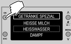
3 Nach der Anwahl von HEISSWASSER durch Druck der Taste "V" oder "∧" mit "OK" bestätigen.
