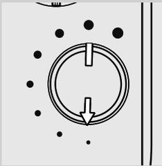
**2** Den Drehknopf für die Mahlgradeinstellung jeweils nur um maximal einen Grad verstellen. Der Geschmacksunterschied ist nach der Ausgabe von 2-3 Espresso wahrnehmbar.
