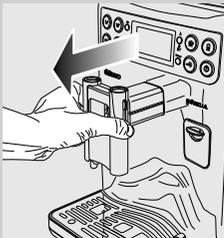
**6** Die Düse herausnehmen und mit Wasser reinigen.
