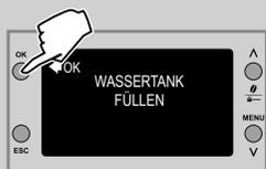
**12** Nach Abschluss der Ausgabe den Tank bis zum Füllstand MAX mit frischem Wasser füllen. Zur Bestätigung die Taste "OK" drücken.
