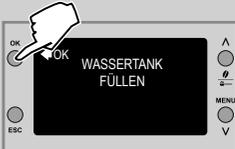
**4** Den Wassertank bis zum Füllstand MAX mit frischem Wasser füllen. Die Taste "OK" drücken.
