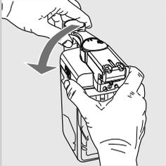
**7** Die Milchdüse in die Sperreposition bringen, indem sie im Gegenuhrzeigersinn gedreht wird.
