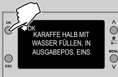
**11** Die Milchkaraffe entleeren und mit frischem Wasser füllen. Wieder in die Maschine einsetzen. Die Taste "OK" drücken.
