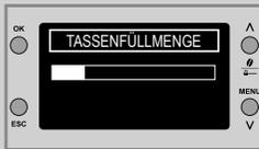
Durch Einstellung der Leiste auf dem Display mit den Tasten "V" oder "^" kann die Wassermenge für die Kaffeeausgabe angewählt werden. Die Taste "OK" drücken, um die Änderung zu bestätigen.
