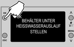
**13** Die Taste "OK" drücken, um das Vorhandensein eines Behälters unter der Wasserdüse zu bestätigen.
