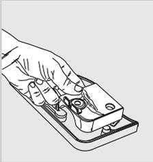
**4** Den Halter unter dem Rost herausnehmen. Den Halter und die Abtropfschale reinigen.
