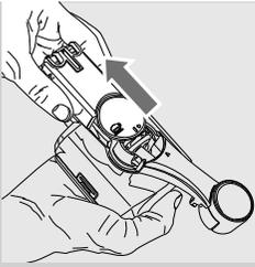
**5** Den Steckverbinder an die Maschine abnehmen.
