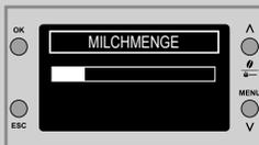
Durch Einstellung der Leiste auf dem Display mit den Tasten "V" oder "^" kann die Milchmenge für die Zubereitung des angewählten Getränks angewählt werden. Die Taste "OK" drücken, um die Änderung zu bestätigen.
