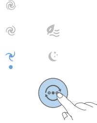
يمكنك اختيار سرعة المروحة 1 أو سرعة المروحة 2 أو سرعة المروحة 3 من خلال لمس زر ✕ في الجهاز أو الضغط على زر +/- في جهاز التحكم عن بُعد يدويًا.
