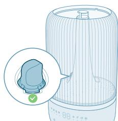
٤ املأ خزان المياه بالمياه. لا تملأ بالمياه الساخنة.
