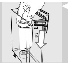
**11** Filter vode "INTENZA+" vstavite v prazen rezervoar za vodo. Potisnite ga kolikor gre navzdol.
