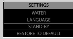
**STAND-BY** določa, v kolikšnem času po zadnjem točenju se aparat preklopi v stanje pripravljenosti. Stanje pripravljenosti lahko traja 15, 30, 60 ali 180 minut.
