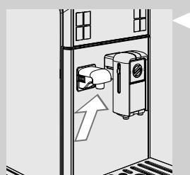
**14** Preverite, da je pipa za točenje vode pravilno nameščena.
