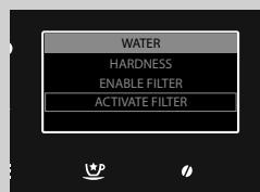
**V ENABLE FILTER** se izvede aktiviranje filtra po njegovi namestitvi ali zamenjavi. Glejte poglavje "Namestitev filtra vode INTENZA+".
