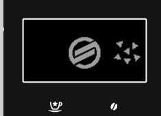
Med uporabo v notranjosti aparata nastaja vodni kamen, ki ga je potrebno redno odstranjevati; v nasprotnem primeru se lahko vodni obtok in obtok za kavo zamašita. Aparat opozori, kdaj je potrebno odstraniti vodni kamen. Če se na zaslonu aparata prikaže simbol, je potrebno odstraniti vodni kamen.
