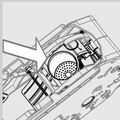
**7** Sklop za kavo skrbno operite z mlačno vodo in skrbno očistite filter sklopa za kavo.
