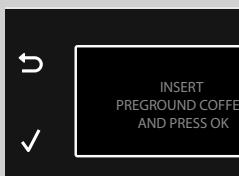
**8** Pritisnite tipko "✓". Po izvedbi cikla predkuhavanja, kava začne teči iz pipe za točenje.
