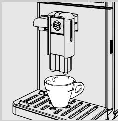
**2** Pridržite tipko za ekspres kavo "ESPRESSO", dokler se ne pojavi ikona "MEMO", nato spustite tipko. Sedaj se aparat programira. Aparat prične točiti kavo.
