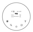
· 预热过程中,屏幕上会显示"---"。 一分钟后,空气净化器会在测量空 气质量后显示甲醛/PM2.5/气态污染 物级别。如果一分钟内未显示甲醛/ 气态污染物/温湿度读数,请检查 是否安装了灵智感应空气传感器。
