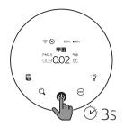
• 轻触并按住 ① 按钮 3 秒可关闭空气 净化器。
