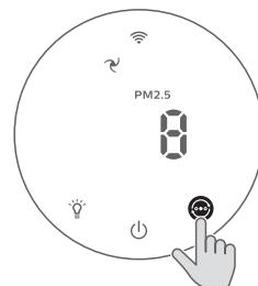
**Vitesse manuelle (1 et 2)** : en mode manuel, le purificateur d'air fonctionne à la vitesse 1 ou 2.
