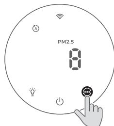
**Mode automatique (A)** : le purificateur d'air règle automatiquement la vitesse du ventilateur en fonction de la qualité de l'air ambiant.
