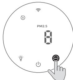
**Modo automático (Ⓐ):** el purificador de aire ajusta automáticamente la velocidad del ventilador según la calidad del aire ambiente.
