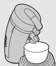
**8** Placez un bol (d'une capacité minimale de 1 500 ml) sous les orifices d'écoulement du café pour recueillir l'eau.
