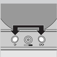
**10 Druk de 1-kops knop ♂ en de 2-kops knop ♂♂ tegelijkertijd kort in.** De boiler vult zich met water uit het waterreservoir. Dit kan enige tijd duren (ong. 90 tot 150 seconden). De machine schakelt automatisch uit wanneer het doorspoelen is beëindigd. Het doorspoelen maakt meer geluid dan gewoon koffiezetten.
