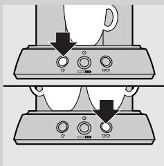
**8** Placez une ou deux tasses sous les orifices d'écoulement. Vous pouvez régler la hauteur de l'unité d'écoulement en la faisant glisser vers le haut ou vers le bas.
