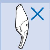
**►** No sostenga el aparato con el compartimento para el polvo mirando hacia arriba, ya que el líquido podría penetrar en el aparato y deteriorar las piezas del interior.
