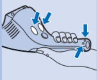
**1** Lassen Sie den Motor laufen, bis er stillsteht. Lösen Sie die Schrauben und öffnen Sie das Gerät.
