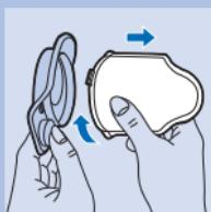
**3** Nehmen Sie den Filter mit einer leichten Drehung im Uhrzeigersinn vom Filterhalter.
