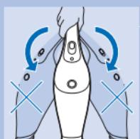
**2** A la hora de aspirar líquidos, mantenga el aparato con el compartimento para el polvo mirando en ángulo hacia abajo. Asegúrese de que la escobilla de goma toca la superficie que desea limpiar. No incline el aparato hacia un lado.
