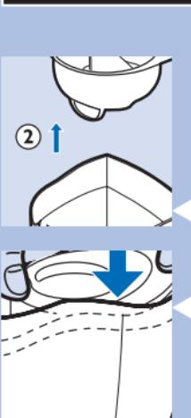
Bevor Sie mit dem Saugen flüssiger oder trockener Substanzen beginnen, müssen Sie den Deflektor und den Filter in die Staubkammer eingesetzt haben.
