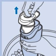
**1** Appuyez sur le bouton de verrouillage et ouvrez l'aspirateur au dessus d'une poubelle.
