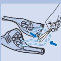
**2** Durchtrennen Sie jeden Verbindungsdräht einzeln und nehmen Sie die Akkus heraus.
