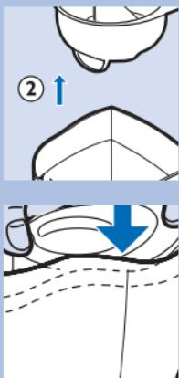
Zorg ervoor dat de deflector en het filter in het stofvak geplaatst zijn voordat u het apparaat gaat gebruiken om droge stoffen dan wel vloeistoffen op te zuigen.
