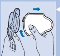
**3** Tournez le filtre doucement dans le sens des aiguilles d'une montre pour le détacher du support.
