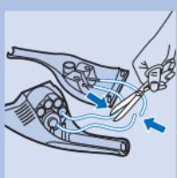
**1** Αφήστε τη συσκευή να λειτουργήσει μέχρι να σταματήσει, ζεβιδώστε τις βίδες και ανοίξτε το ηλεκτρικό σκουπάκι.
