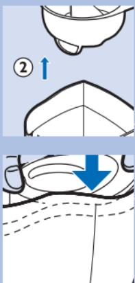
Controllate che l'adattatore e il filtro siano stati inseriti nello scomparto della polvere prima di usare l'apparecchio per aspirare materiali solidi o liquidi.
