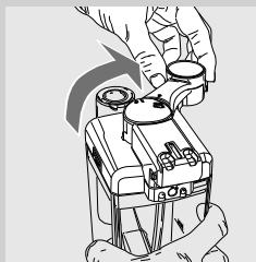
**1** Otvorite blok za ispuštanje posude za mleko okrećući ga u smeru okretanja kazaljki na satu.
