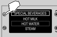
**3** Nakon što ste odabrali HOT WATER pritiskom na taster za prelistavanje "V" ili "A", potvrđite sa "✓".
