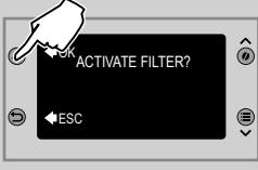
**11** Pritisnite taster "✓" da biste potvrdili da želite da pokrenete proceduru aktiviranja filtera.
