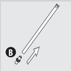
**13** Insérer le raccord (B) dans le tuyau d'aspiration.
