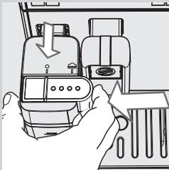
11 Une fois la distribution terminée, si on ne souhaite pas effectuer le cycle de rinçage automatique de la carafe, fermer la buse de distribution de la carafe en la faisant glisser jusqu'au symbole « ● ».
