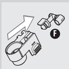
8 Retirer le raccord (F) du mousser à lait en le tirant vers l'extérieur.
