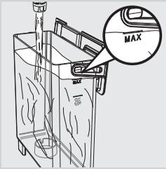
15 À la fin de cette opération, remplir de nouveau le réservoir à eau jusqu'au niveau MAX. La machine est à présent prête à distribuer du café.
