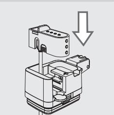
**6** Après avoir installé le tuyau d'aspiration avec le raccord, insérer la buse de distribution de la carafe dans la partie supérieure de la carafe.
