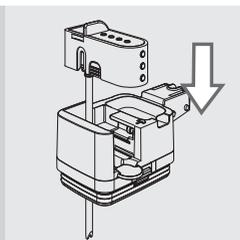
**15** Insérer la buse de distribution dans la partie supérieure de la carafe.
