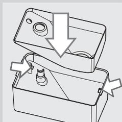
**6** Après le nettoyage et l'essuyage, réinsérer le plateau dans le réservoir à café en grains. Insérer les crochets du plateau dans les logements appropriés du réservoir.
