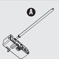
**4** Enlever le tuyau d'aspiration avec le raccord (A) du mousser à lait.
