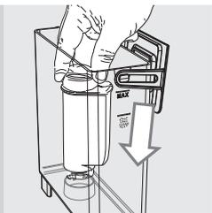
**11** Introduire le filtre à eau « INTENZA+ » dans le réservoir à eau vide. Le pousser jusqu'au point le plus bas possible.
