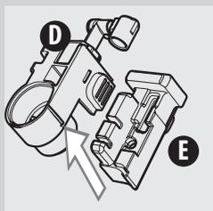
7 Démonter le mousser à lait (D) du support (E).
