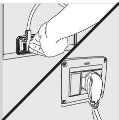
**11** Brancher la fiche sur la prise de courant placée au dos de l'appareil.
