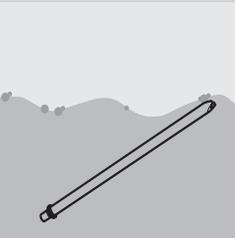
**5** Laver soigneusement le tuyau avec le raccord en utilisant de l'eau fraîche.
