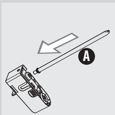
**14** Insérer le tuyau d'aspiration avec le raccord (A) dans le mousser à lait.
