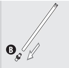
5 Retirer le raccord (B) du tuyau d'aspiration.
