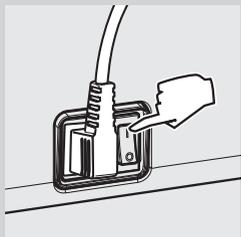
**13** Mettre l'interrupteur général, qui se trouve au dos de l'appareil, sur « I » pour mettre la machine en marche.
