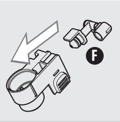
**10** Insérer le raccord (F) dans le mousser à lait en le poussant jusqu'à la butée.
