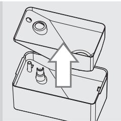
**5** Retirer le plateau. Nettoyer le plateau et le réservoir avec un chiffon humide.
