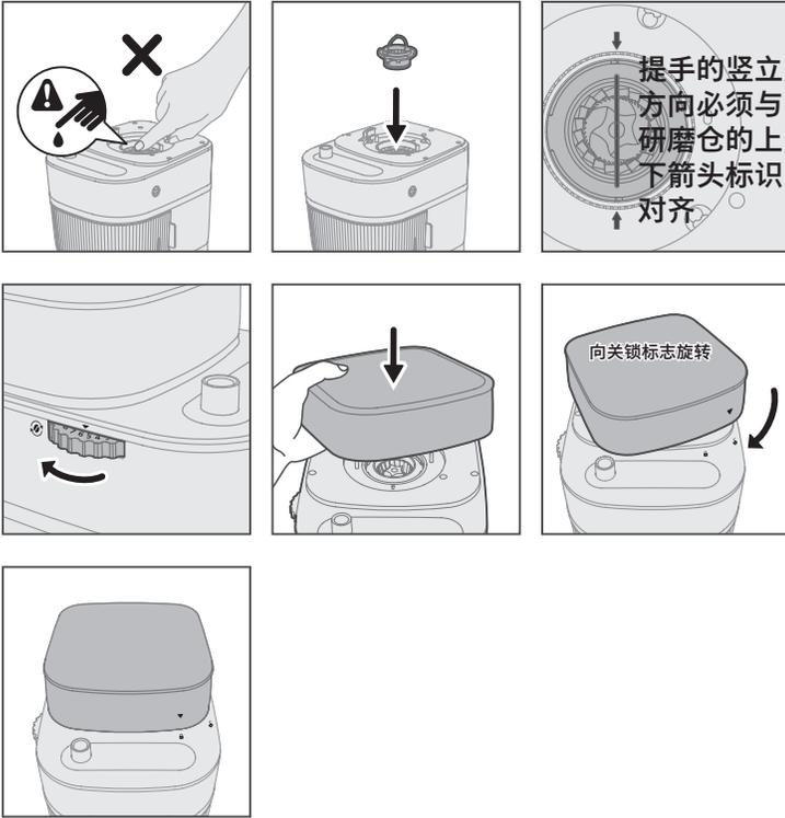
安装提示：此图标 ▼ 对准开锁标志后，旋转至关锁位置（注意：禁止豆仓盒垂直按压！）
