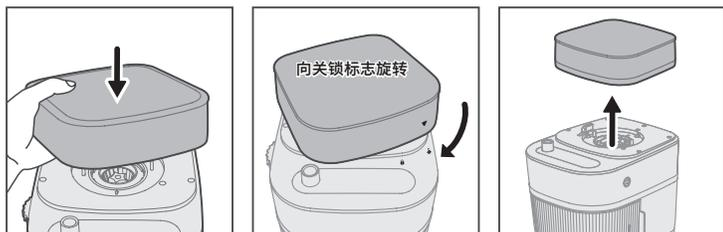
安装提示：此图标 ▼ 对准开锁标志后，旋转至关锁位置(注意：禁止豆仓盒垂直按压！)
