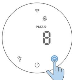
**Mode Turbo (
