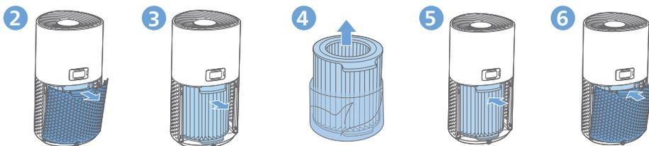
2 Tirez sur le cache arrière pour le détacher de l'appareil.
