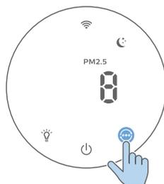
**Mode Veille (
