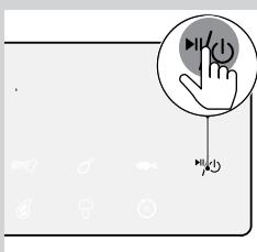
1 Gatavošanas procesa laikā turiet nospiestu ieslēgšanas/izslēgšanas pogu, lai apturētu gatavošanas procesu. Pēc tam ierīce ir gaidīšanas režīmā.
