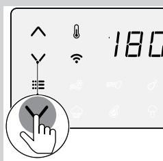
6 A hőmérséklet növelése vagy a hőmérséklet csökkentése gombbal válassza ki a szükséges hőmérsékletet.
