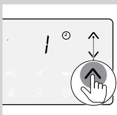
7 Az idő növelése vagy csökkentése gombbal válassza ki a szükséges időt.
