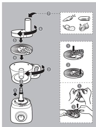
Antes de começar, verifique se a lâmina está encaixada corretamente no disco plástico.
