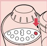
Uređaj će u roku od 10 sekundi postepeno povećavati brzinu mešenja do maksimalne vrednosti. Uređaj će nastaviti da radi na ovoj brzini sve dok se ne pritisne stop dugme. Možete smanjivati brzinu do tri puta pritiskom na - dugme. Ako +/- dugme ne reaguje, onda motor već radi na svojoj fizičkoj granici.
