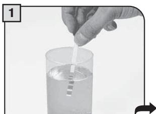
Immergere, per 1 secondo nell'acqua, il provino per i test di durezza dell'acqua, presente nella macchina.
