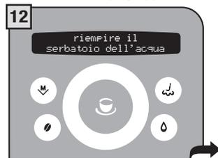
Estrarre il serbatoio dell'acqua, risciacquarlo con acqua fresca potabile per eliminare tracce di soluzione decalcificante, quindi riempirlo con acqua fresca potabile.
