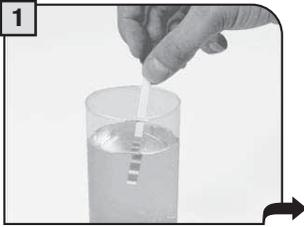
Den Teststreifen für die Wasserhärte für 1 Sekunde in das in der Maschine befindliche Wasser eintauchen.
