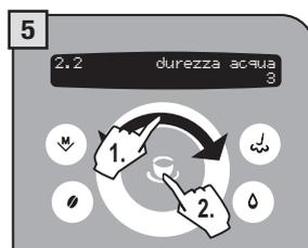
Impostare la durezza dell'acqua sul valore letto sul test e memorizzare.
