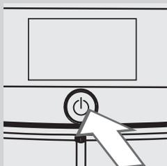
**13** Um das Gerät einzuschalten, muss lediglich die Taste "⏻" gedrückt werden. Das Bedienfeld zeigt an, dass die Entlüftung des Systems vorgenommen werden muss.
