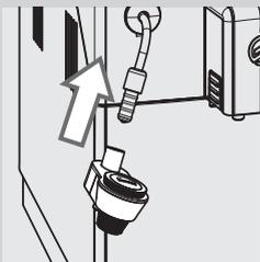
**25** Den kleinen weißen Filter entfernen, den Wasserfilter "INTENZA+" (so weit vorhanden) wieder im Wassertank installieren und den automatischen Milchaufschäumer einsetzen.
