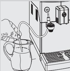
**3** Den Ansaugschlauch in den Behälter einstecken.
