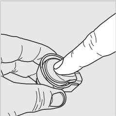
**21** Den Deckel montieren, indem er im mittleren Teil aufgedrückt wird. Sicherstellen, dass er korrekt installiert ist.
