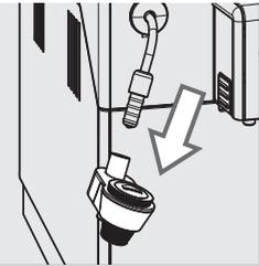
2 Den automatischen Milchaufschäumer von der Dampf-/Heißwasserdüse abziehen.
