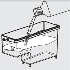
6 Den Wassertank herausnehmen und den gesamten Inhalt des Entkalkungsmittels einfüllen. Dann den Wassertank bis zum Füllstand Calc Clean mit frischem Wasser füllen.
