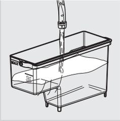
**17** Wenn der Wassertank leer ist, diesen herausnehmen, ausspülen und bis zum Füllstand MAX mit frischem Wasser füllen. Wieder ins Gerät einsetzen.
