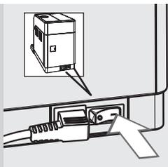
**12** Den Hauptschalter auf die Position "I" stellen, um das Gerät einzuschalten. Die Taste "⏻" blinkt.
