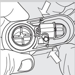
**22** Den automatischen Milchaufschäumer auf dem Anschluss montieren, und sicherstellen, dass er in seiner Aufnahme korrekt befestigt wurde.
