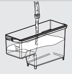
12 Den Wassertank herausnehmen, ausspülen und bis zum Füllstand MAX mit frischem Wasser füllen. Wieder ins Gerät einsetzen. Wird der Wassertank ins Gerät eingesetzt, so wird das folgende Display angezeigt.
