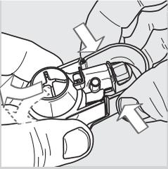
**18** Für die Abnahme des automatischen Milchaufschäumers wird auf die Seiten gedrückt und der Milchaufschäumer mit leicht seitlichen Bewegungen herausgenommen, wie in der Abbildung gezeigt.
