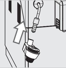
25 Den automatischen Milchaufschäumer in den Gummischutz einstecken, bis er einrastet.
