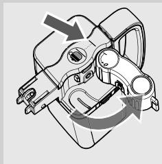
**2** Otvorite blok za ispuštanje na posudi okrećući ga u smeru suprotnom od okretanja kazaljki na satu dok ne škljocne u pravilnom položaju.
