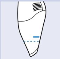
**3** Deje de aspirar líquidos cuando el nivel de líquido dentro del compartimento para el polvo haya alcanzado la línea indicadora del nivel máximo.
