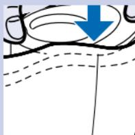
Controllate che l'adattatore e il filtro siano stati inseriti nello scomparto della polvere prima di usare l'apparecchio per aspirare materiali solidi o liquidi.
