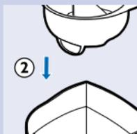
Bevor Sie mit dem Saugen flüssiger oder trockener Substanzen beginnen, müssen Sie den Deflektor und den Filter in die Staubkammer eingesetzt haben.
