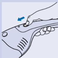
**1** Coloque el interruptor deslizante en la posición I para lograr una potencia de succión normal.
