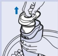
**2** Nehmen Sie den Filter und den Deflektor aus der Staubkammer.
