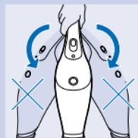
**2** När du suger upp vätskor ska du hålla dammsugaren med dammfacket så att det är riktat mot golvet i vinkel. Gummirakan ska ligga an mot ytan som du rengör. Tippa inte dammsugaren åt sidan.
