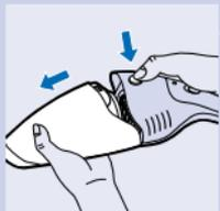
**1** Ta ut vattenavvisaren och filtrets ram från dammfacket.
