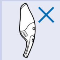
► Håll inte dammsugaren så att dammfacket är riktat uppåt. Om du gör det kan vätska rinna in i dammsugaren och skada komponenterna i den.
