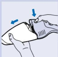
**1** Nehmen Sie den Deflektor und den Filterhalter aus der Staubkammer.
