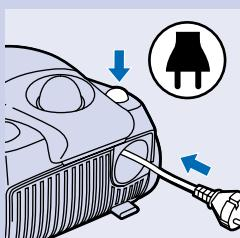
**1** Vysavač vypněte a jeho síťovou zástrčku vytáhněte ze zásuvky. Stisknutím nášlapného spínače naviňte přívodní kabel zpět do vysavače.
