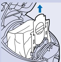
**3** Выньте полный мешок-пылесборник, потянув вверх за картонный язычок, при этом мешок-пылесборник автоматически закрывается.
