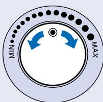
**4** Sūkšanas jaudu varat regulēt, izmantojot elektronisko jaudas regulatoru (tikai atsevišķiem modeļiem).
