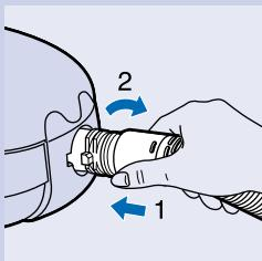
**1** Spojite cijev tako da je utaknete u usisivač i zakrenete udesno.
