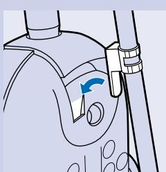
**2** Helyezze a készüléket függöleges helyzetbe és csatlakoztassa az alsó csövet a készülékhez a pattintóval.
