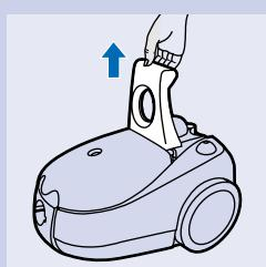
**2** Za prenošenje usisivača, postavite ručku u uspravni položaj.
