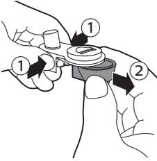
**4** Pentru a detașa dispozitivul automat de spumare a laptelui, apăsați pe părțile laterale (1) și scoateți-l trăgându-l în afară cu ușoare deplasări laterale (2).
