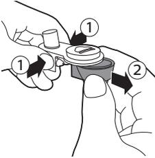
**4** Az automatikus tejhabosító leszereléséhez nyomja össze a fedelének a két oldalát (1), és a tejhabosító eltávolításához húzza azt kifelé, finoman oldalirányban mozgatva (2).
