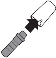
**Figyelem! Ne nyomja a gumi csőösszekötőt a gőzcsővön található vonalakon túl. Ha túlságosan rányomja, az automatikus tejhabosító nem fog megfelelően működni, mert nem tud tejet felszívni a tejesdobozból.**
