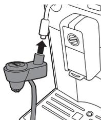
**2** Dugja az automatikus tejhabosítót a krómzott burkolaton található gumicsatlakozóra.
