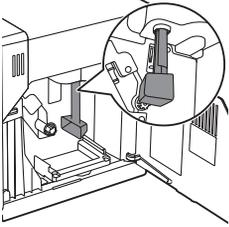
**7** Egy kanál nyelével vagy a készülékhez mellékelte multifunkciós eszközzel alaposan tisztítsa ki a kávékieresztő csövet. Helyezze be az ábrán látható módon.
