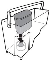
**21**Helyezze az AquaClean szűrőt függőlegesen a szűrőcsatlakozóra. Nyomja le az AquaClean szűrőt ütközésig. A legjobb eredmény elérése érdekében győződjön meg arról, hogy a szűrő szorosan illeszkedik, és a tömítés megfelelő helyzetben áll.
