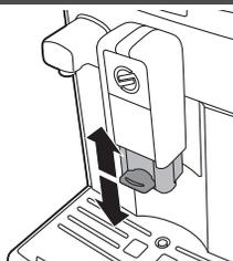
A készülék használható különböző típusú kávék adagolására különböző méretű csészékbe és bögrékbe. A kávéadagoló kifolyója magasságának a csésze vagy bögre méretéhez való beállításához csúsztassa a kávéadagoló kifolyóját felfelé vagy lefelé.
