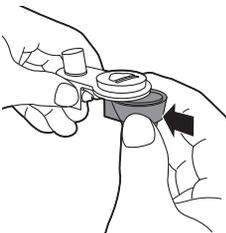
**8** Csatlakoztassa az automatikus tejhabosítót a tejhabosító fedeléhez. Ha két alkatrész a helyére kerül, kattánás hallható.
