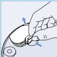
**1** Öffnen Sie das Batteriefach.
