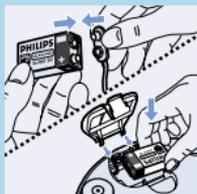
**2** Setzen Sie die Batterie in den Batteriehalter ein, und schließen Sie das Batteriefach.
