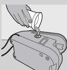
6 Fyld dampgeneratoren med frisk vand, og ryst den igen.
