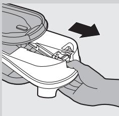
Nunca retire a tampa de enxaguamento Calc-Clean com o vaporizador quente.
