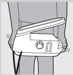
**4** Faites basculer la chaudière sur le côté (bouchon Calc-Clean vers le haut) et retirez le bouchon Calc-Clean.
