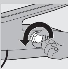
**4** Vänd ånggeneratorn på sidan med avkalkningslocket uppåt och ta sedan bort avkalkningslocket.
