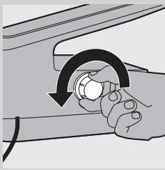
**4** Volte o vaporizador de lado com a tampa de enxaguar Calc-Clean voltada para cima e retire a tampa.
