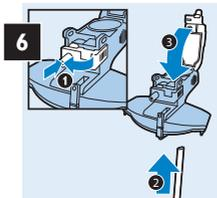
Coloque novamente a entrada de vapor, encaixe bem o tubo no conector da tampa do recipiente para leite e feche a tampa.
