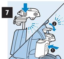
Encaixe a tampa novamente, coloque o recipiente para leite na máquina e pressione a alavanca para baixo.
