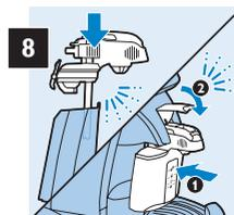
8 Encaixe a tampa novamente, coloque o recipiente para leite na máquina e pressione a alavanca para baixo.
