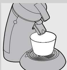
**8** Placez un bol (d'une capacité minimale de 1 500 ml) sous l'unité d'écoulement du café pour recueillir l'eau.
