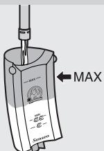
2 Remplissez le réservoir jusqu'au niveau **MAX** avec de l'eau fraîche, puis remettez-le en place.
