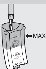
Wanneer u de koffiemachine drie dagen niet hebt gebruikt, moet u de machine voor gebruik doorspoelen met vers water.
