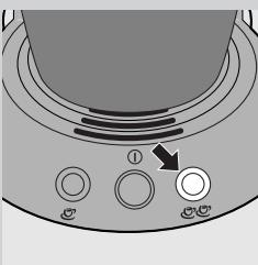
**6** Druk op de 2-kops knop en laat de machine werken. Herhaal dit totdat het waterreservoir leeg is.
