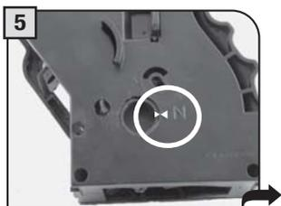
Asegurarse de que el grupo esté en posición de reposo; los dos triángulos de referencia deben coincidir.
