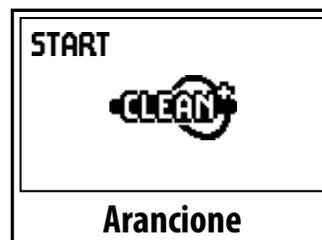
Dopo una serie di erogazioni latte, girare verso destra il pomello principale come per ottenere l'erogazione di acqua calda: apparirà l'immagine "CLEAN+": porre un recipiente sotto l'erogatore e premere il pulsante superiore sinistro per iniziare l'operazione di pulizia; dopodichè riportare il pomello in posizione centrale per poter eseguire altri programmi di erogazione.
