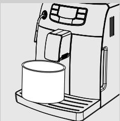
**8** Colocar un recipiente grande (1,5 l) bajo el tubo de vapor/agua caliente y bajo la salida de café.
