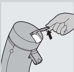
**2 Remplissez le réservoir jusqu'au niveau **MAX** avec de l'eau fraîche, puis remettez-le en place.**
