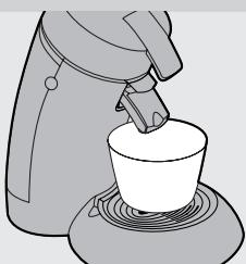
**3** Placez un bol (d'une capacité minimale de 1 500 ml) sous l'unité d'écoulement du café pour recueillir l'eau.
