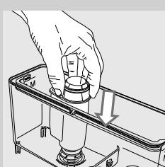
**4** Вставте фільтр в порожній водяний бачок. Штовхніть його до найнижчої точки.
