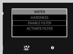
**U ENABLE FILTER** aparat upozorava korisnika na potrebu zamene filtera za vodu.
