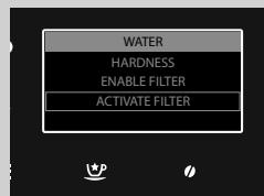
**U ACTIVATE FILTER** izvršava se aktiviranje filtera nakon njegove ugradnje ili izmene. Pogledajte poglavje "Ugradnja filtera za vodu INTENZA+".
