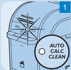
**1** Lorsque la fonction anticalcaire automatique est activée, le voyant anticalcaire automatique bleu clignote et l'appareil émet des bips. La fonction s'exécute en 3 minutes environ. Durant l'exécution de cette fonction, le système peut émettre des bruits de pompe et des cliquetis.
