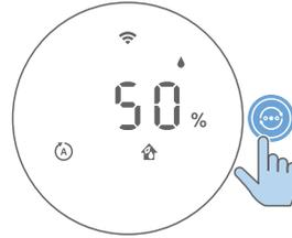
**الوضع التلقائي (Ⓐ):** يضبط الجهاز سرعة المروحة تلقائيًا بما يتناسب مع جودة الهواء المحيط.
