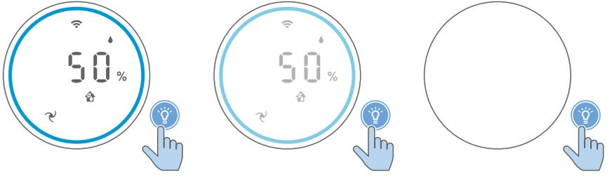
يفضل مستشعر الضوء، يتم تشغيل لوحة التحكم أو إيقاف تشغيلها أو تعميمها وفقًا للضوء المحيط. سيتم إيقاف تشغيل لوحة التحكم أو تعميمها عندما يكون الضوء المحيط مطلقًا. يمكنك لمس أي زر لتشغيل كل الأضواء والتحقق من جودة الهواء. بالتالي، إذا لم يتم إجراء أي عملية إضافية، فسيتم إيقاف تشغيل كل الأضواء أو خفتها مجددًا لتناسب مع الضوء المحيط.
