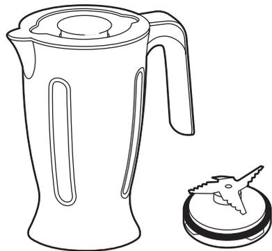
PT Copo de liquidificador com tampa, copo medidor e unidade de lâminas destacável com anel de vedação.
